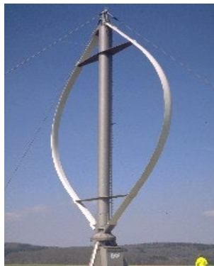
Ilustración 9 Generador vertical tipo Darrieus.
