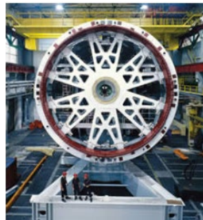
Ilustración 19 Rotor del alternador del E-112
