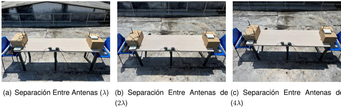
Fig 3.62: Montaje de Escenario en Exteriores con Distancia entre Transmisor y Receptor de 2m.
