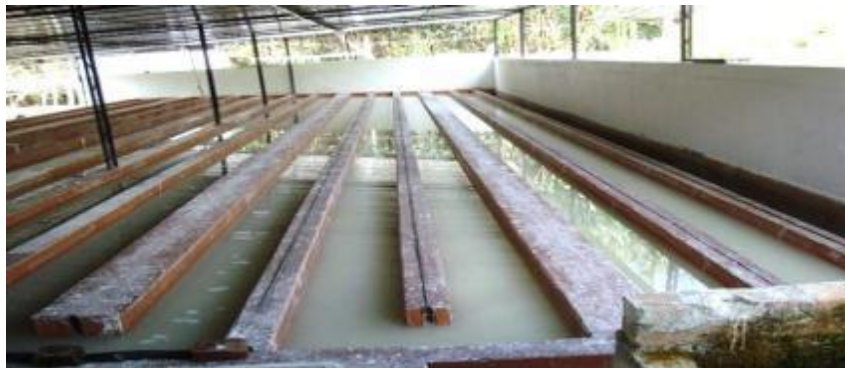
Imagen 11 Canales de Sedimentación de Almidón Agrio de Yuca en uso
