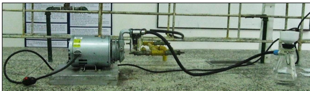
Figura 43. Equipo de filtración al vacío, para separar las bacterias de la solución cianurada
