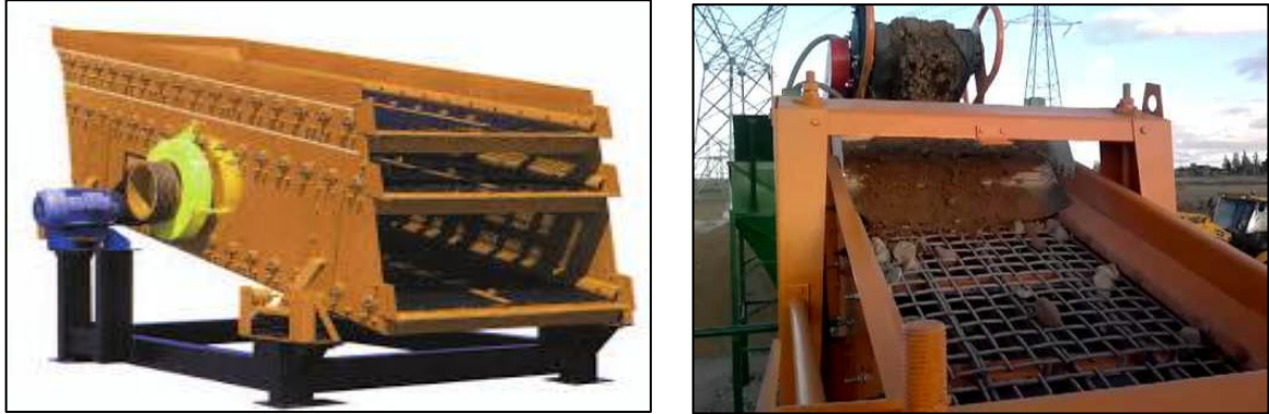
Figura 11. Vista lateral y frontal de una Harnero industrial de estratificación. (Fuente: wilde.cl)
