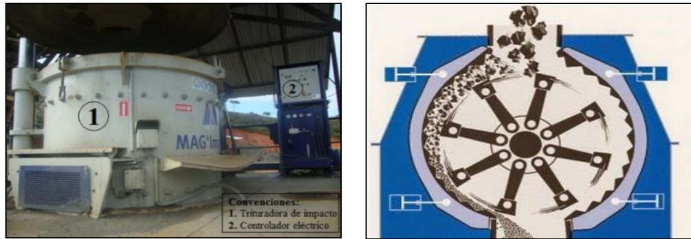
Figura 8. Imagen de un triturador giratorio o impactor. (Fuente: Chavez.T.J)
