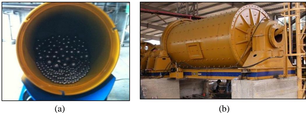
Figura 9. (a) Parte interior de un molino de bolas, con su respectivo medio de molienda (bolas de acero); (b). Parte exterior de un molino de bolas. (Fuente: Mine Machinery co. LTD)
