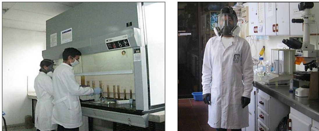
Figura 36. (a). Campana de extracción, encargada de controlar la exposición a vapores, gases y aerosoles tóxicos. (b). Indumentaria básica requerida para trabajar con NaCN en laboratorio
