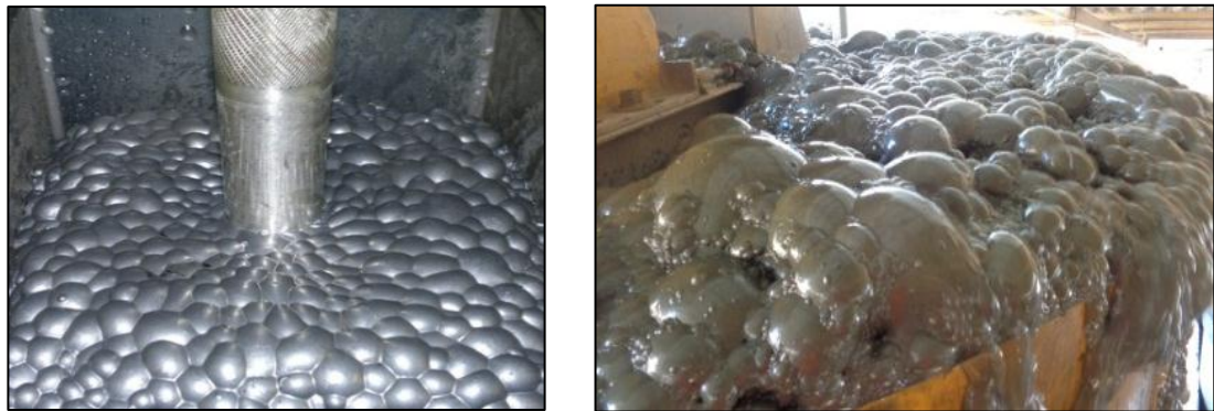
Figura 16. Burbujas y espuma que se forman en la parte superior de la celda de flotación.
