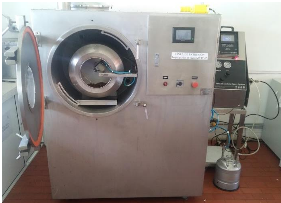
Figura 18. Equipo de impregnación al vacío MP/TV05 y módulo AutoJet ensamblado totalmente.
