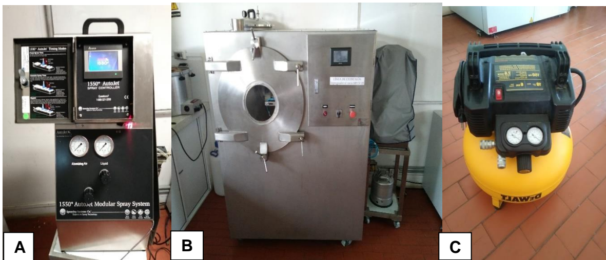
Figura 1. Módulo de aspersión Autojet, impregnador al vacío y compresor DeWalt.
