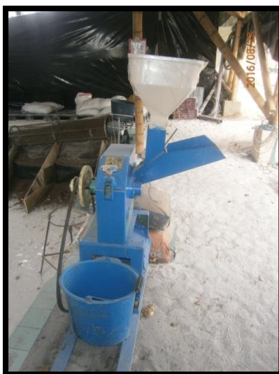
Figura 16 – Maquinaria para picar moler y cernir los abonos del sistema de Procesos de Bioinsumos del SENA
