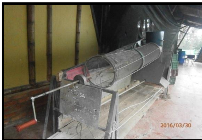
Figura 15 – Maquina para clasificar granulometría de los abonos inventada por María del Socorro Anaya docente de Procesos de Bioinsumos del SENA
