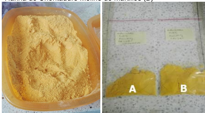
Figura 12. Harina de chontaduro. Obtención y Harina de Chontaduro en Molino de Cuchillas (A) - Harina de Chontaduro Molino de Martillos (B)
