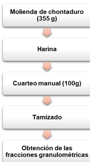
Figura 6. Diagrama de flujo del procedimiento para la obtención de las fracciones de la harina de chontaduro
