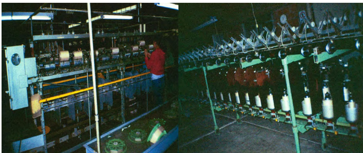
Figura 7. Torsión de filamentos para 48 puestos y Enconadoras de seda.
