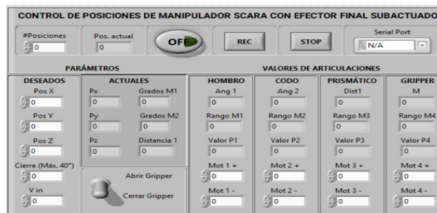
Figura 1: "Front" panel para controlar y visualizar los parámetros del manipulador SCARA [1]
