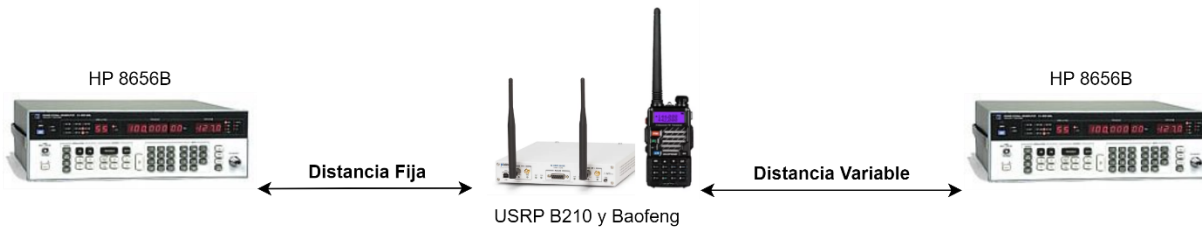
Fig. 29. Configuración experimental en un escenario de laboratorio. Fuente: Elaboración propia.
