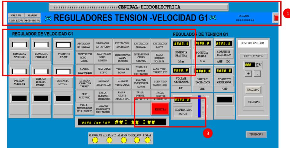
Figura 12: Pantalla Regulador de tensión unidad 1 central hidroeléctrica
