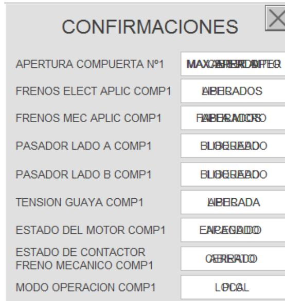
Figura 58: Pantalla Confirmaciones compuerta unidad 1 alto rendimiento
