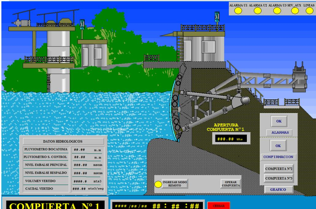
Figura 13: Pantalla Compuertas unidad 1 central hidroeléctrica
