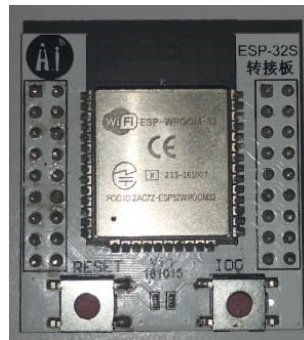
Figura 3.17: Placa integrada con módulo WROOM32. Fuente: Elaboración propia.
