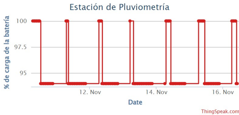
Figura 3.62: Registro nivel de carga de la batería. Fuente: Elaboración propia.
