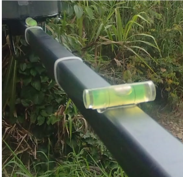
Figura 3.53: Nivelación de estación pluviométrica. Fuente: Elaboración propia.
