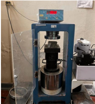
Ilustración 4. Máquina de compresión ROSSEMBERG
