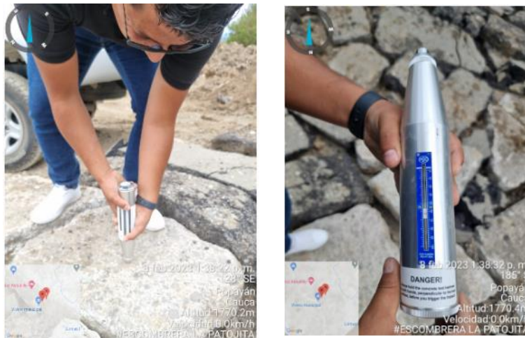
Ilustración 10. Ensayo Esclerómetro – Escombrera
