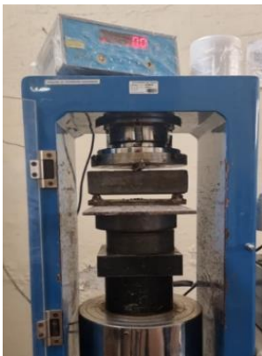
Ilustración 5. Máquina de compresión ROSSEMBERG – Ensayo Flexotracción Modulo De rotura MR
