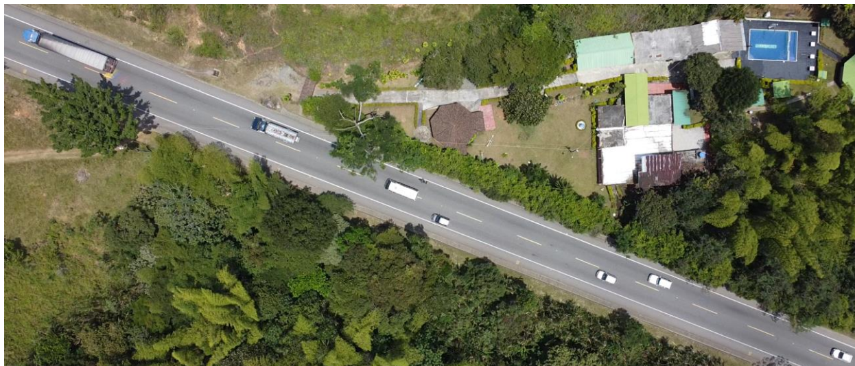
Figura 12. Trayectoria de adelantamiento para una velocidad entre 70 y 85 km/h
