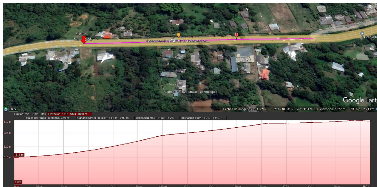
Figura 14. Medición pendiente longitudinal tramo 2
