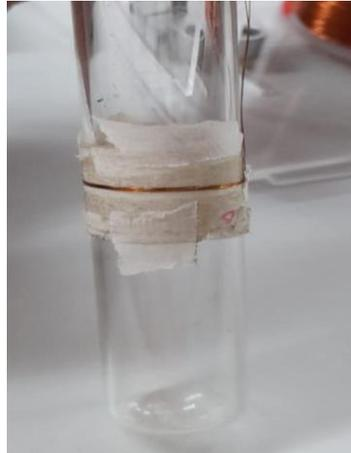
*Figura 17 bobina sensora*
