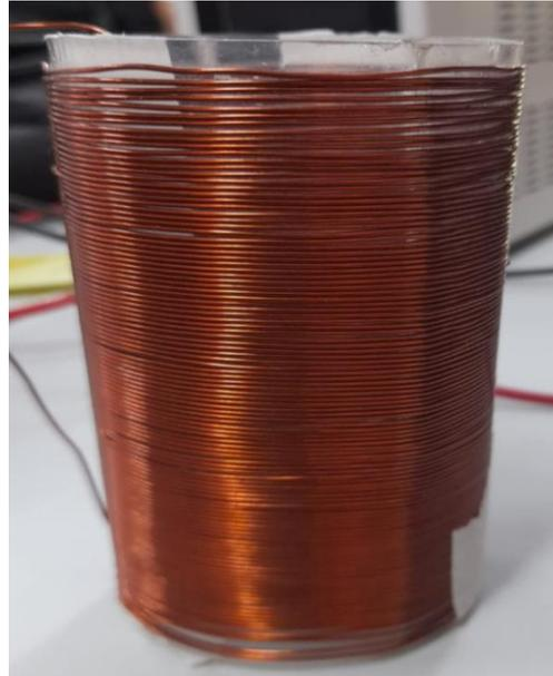
*Figura 13 componentes circuito resonante. a) Banco de capacitores b) bobina generadora.*
