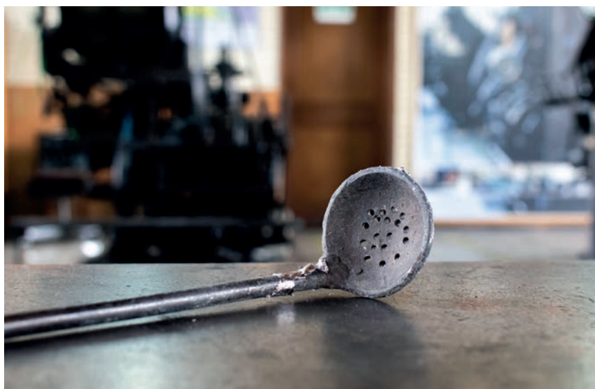
Cuchara con orificios para sacar la escoria o suciedad del caldero
