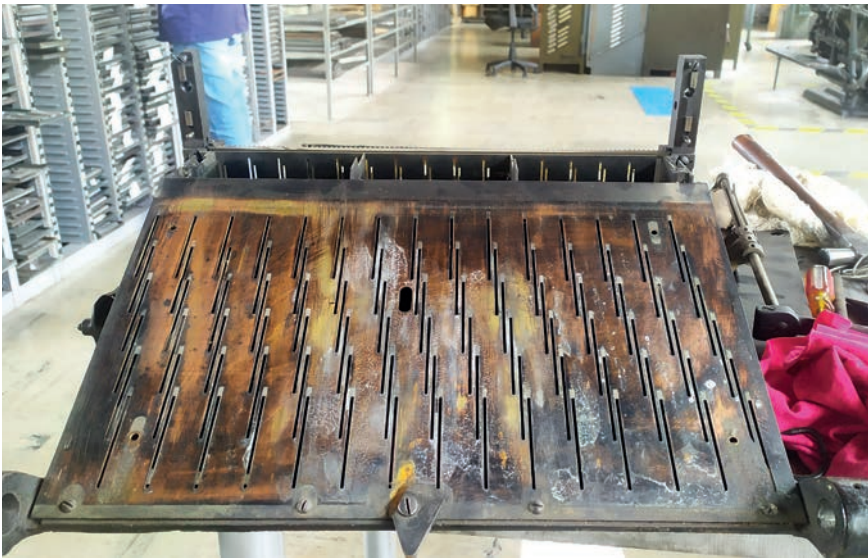
Teclado desarmado máquina Linotype, Modelo 31 - Vista frontal
