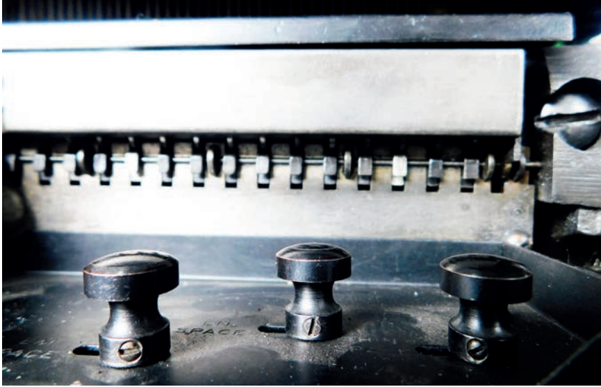
Espaciado automático de la máquina Linotype, Modelo 31
