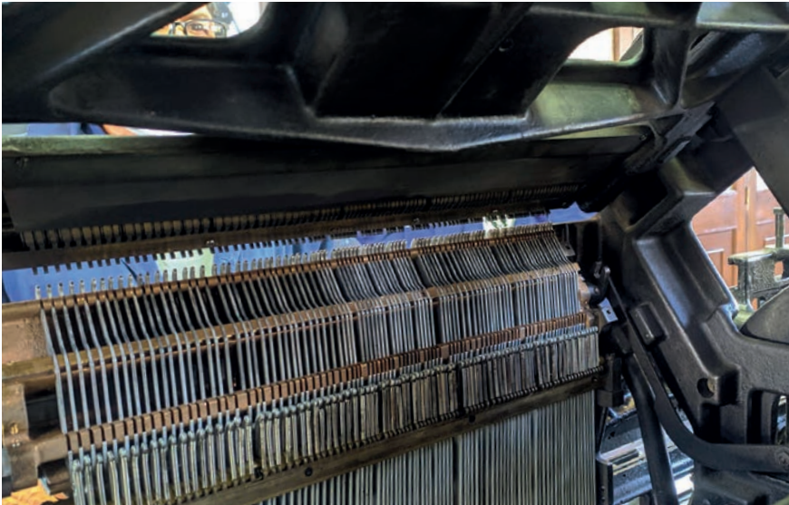
Envarillado de la máquina Linotype, Modelo 31
