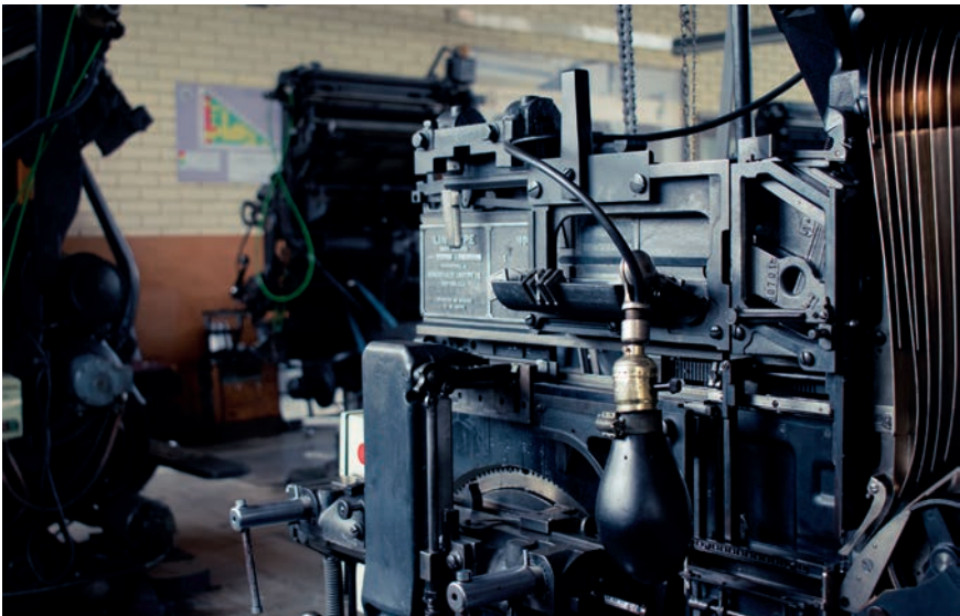
Lámpara, componedor y caja de espacios de banda de la máquina Linotype, Modelo 31
