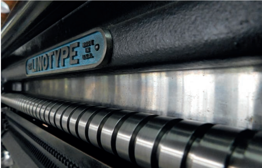
Detalle de tornillo sin fin de la máquina Linotype, Modelo 31
