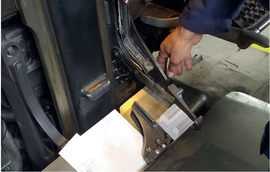
Lingote de plomo por salir de la máquina para completar la composición
