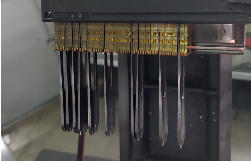
Línea de texto compuesta, Matrices de las letras y espacios de banda
