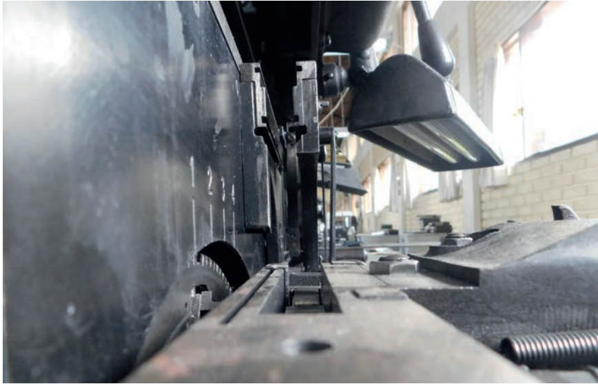
Canal del carro y vista lateral de la máquina Linotype, Modelo 31
