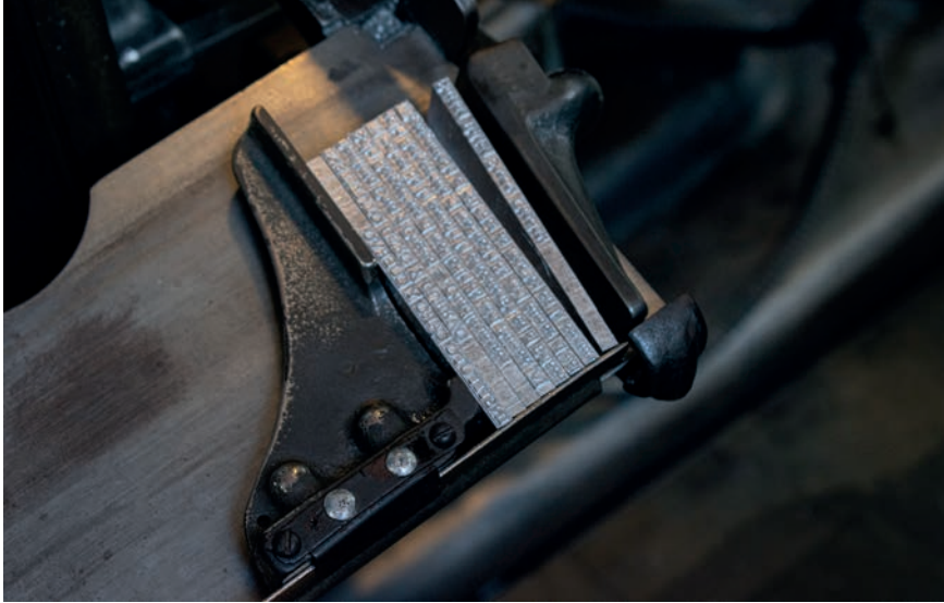
Bandeja con lingotes de plomo producidos por la máquina Linotype, Modelo 31
