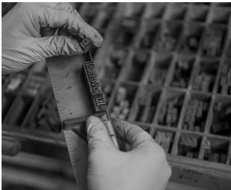
Imagen 1. Componiendo línea de texto con tipos móviles , S. Locos por la tipo, 2015
