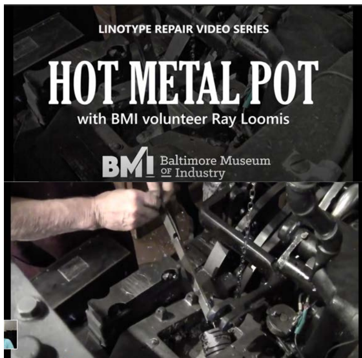
Imagen 22 y 23. Linotipista limpiando el crisol en “Linotype Repair: Hot Metal Pot”, Captura de Pantalla, 2021
