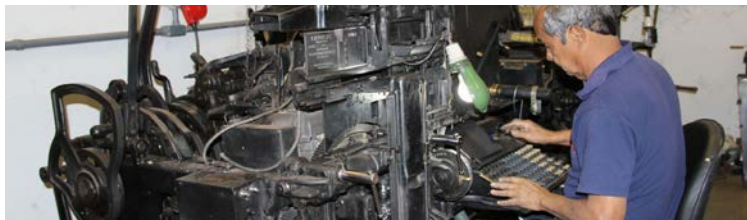
Imagen 11. Linotipias del Taller Tipográfico de la UFG, Ateliê tipográfico: https://tipografia.cegraf.ufg.br , Captura de Pantalla, 2021.
