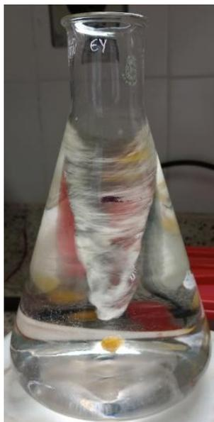
**Figura 10.** Montaje para la purificación de los polímeros
