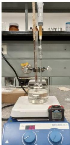
**Figura 11.** Montaje para la determinación de la viscosidad de los polímeros
