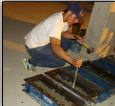
Ilustración N° 67. Toma de Vigas.
