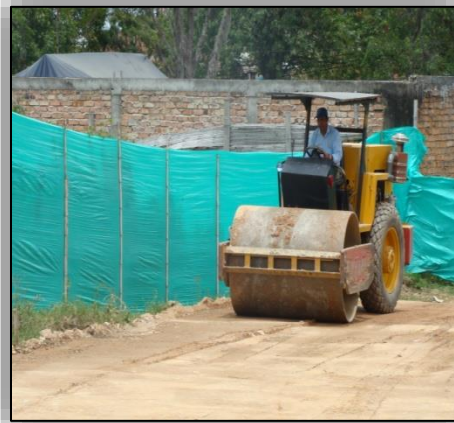
Ilustración N° 14. Vibrocompactador Dinapack CA 15.
