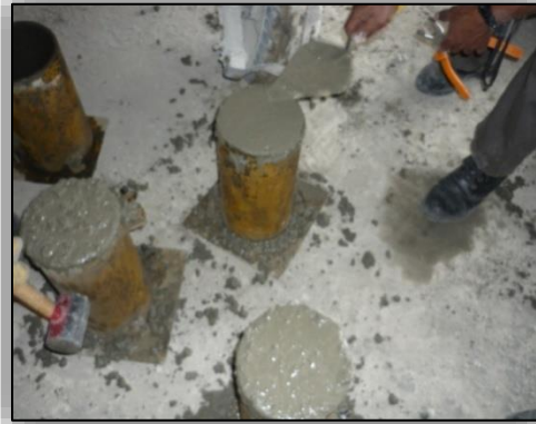
Ilustración N° 66. Toma de Cilindros.
