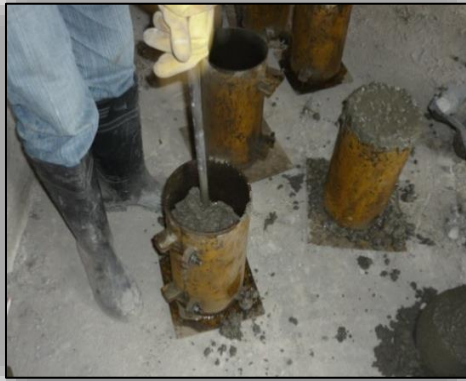
Ilustración N° 66. Toma de Cilindros.
