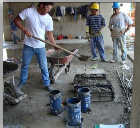
Ilustración N° 67. Toma de Vigas.
