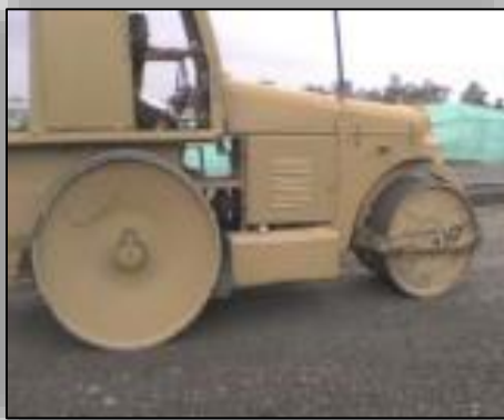
Ilustración N° 26. Compactador de rodillo pequeño llamado Triciclo.
