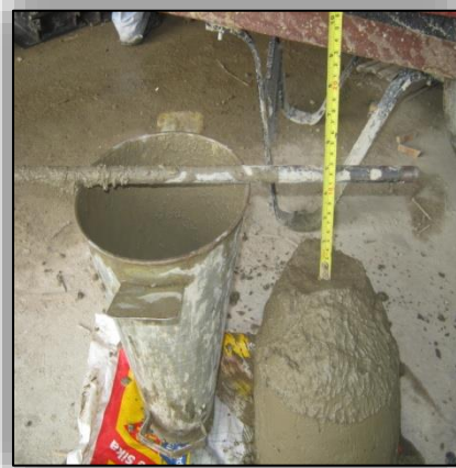
Ilustración N° 65. Ensayo de Asentamiento con el Cono o Slump.
