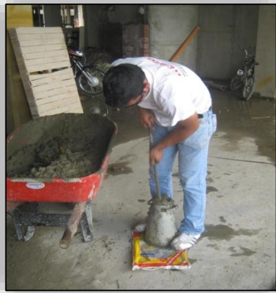
Ilustración N° 65. Ensayo de Asentamiento con el Cono o Slump.
