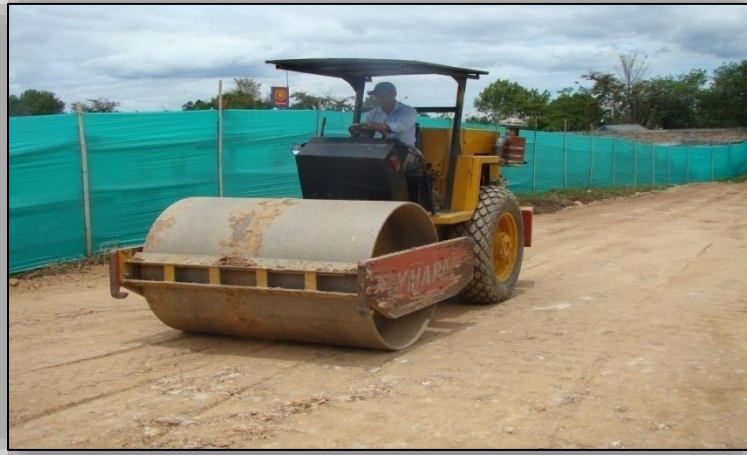
Ilustración N° 18. Vibrocompactador Dinapack CA 15.
