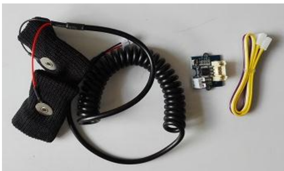
Figura 5. 11. Dispositivo sensor GSR. Fuente: propia.
