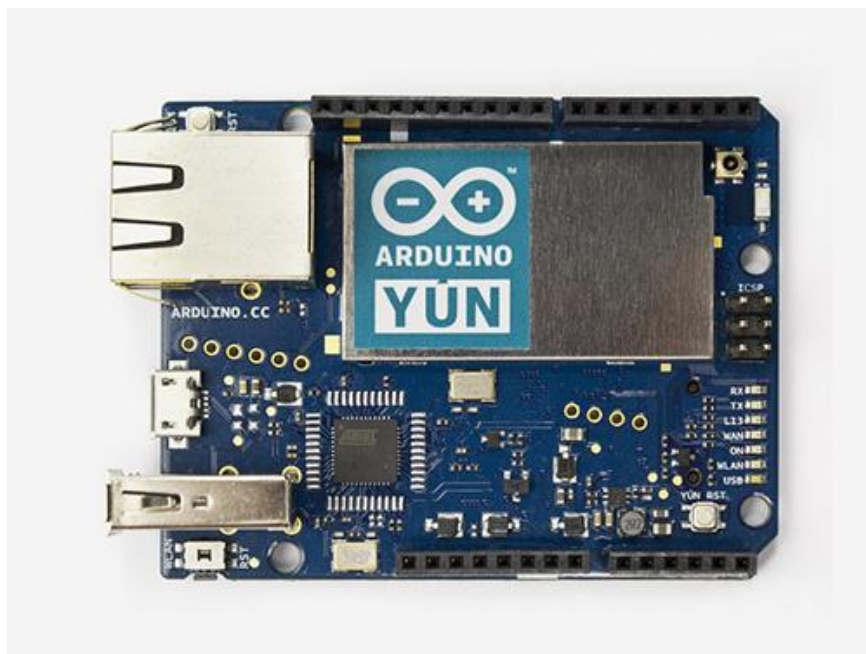
Figura 5. 12. Tarjeta hardware Arduino Yún. Fuente: propia.
