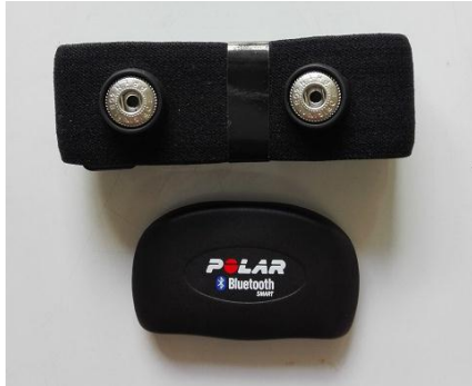
Figura 5. 10. Dispositivo sensor polar. Fuente: propia.
