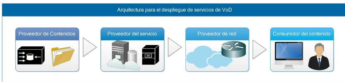
Figura 4. 22. Arquitectura para el despliegue del servicio de VoD. Fuente: propia.
