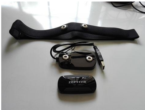
Figura 5. 9. Dispositivo sensor zephyr. Fuente: propia.
