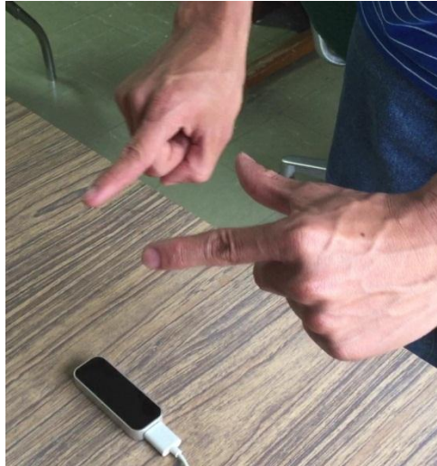
Figura 11. Posición correcta de los dedos para abrir y cerrar pinza.
