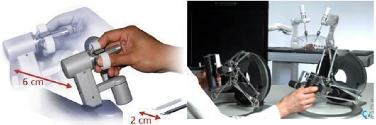
Figura 22. Controles de robots quirúrgicos. Izquierda: Joystick del robot Da Vinci, desplazamiento del mando y su respuesta en el terminal del robot. Derecha: Control Omega.
