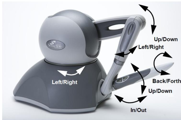
Figura 3.1: Movimientos del OmniPhantom [4]
