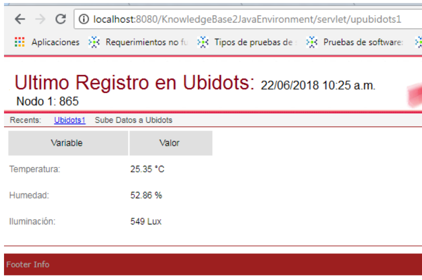
Figura 4.14. Último registro del middleware subiendo datos a Ubidots.
