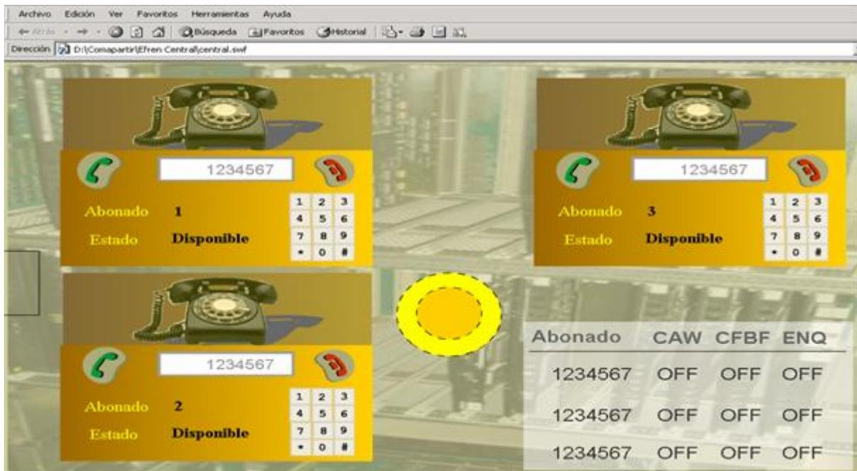
Figura 5.3 Interfaz de usuario del simulador de servicios especiales del laboratorio remoto AXE-10
