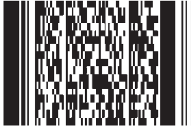
Figura 6. Ejemplo de código de barras 2-D con el estándar PDF 417. Adaptado de BarCode 1
