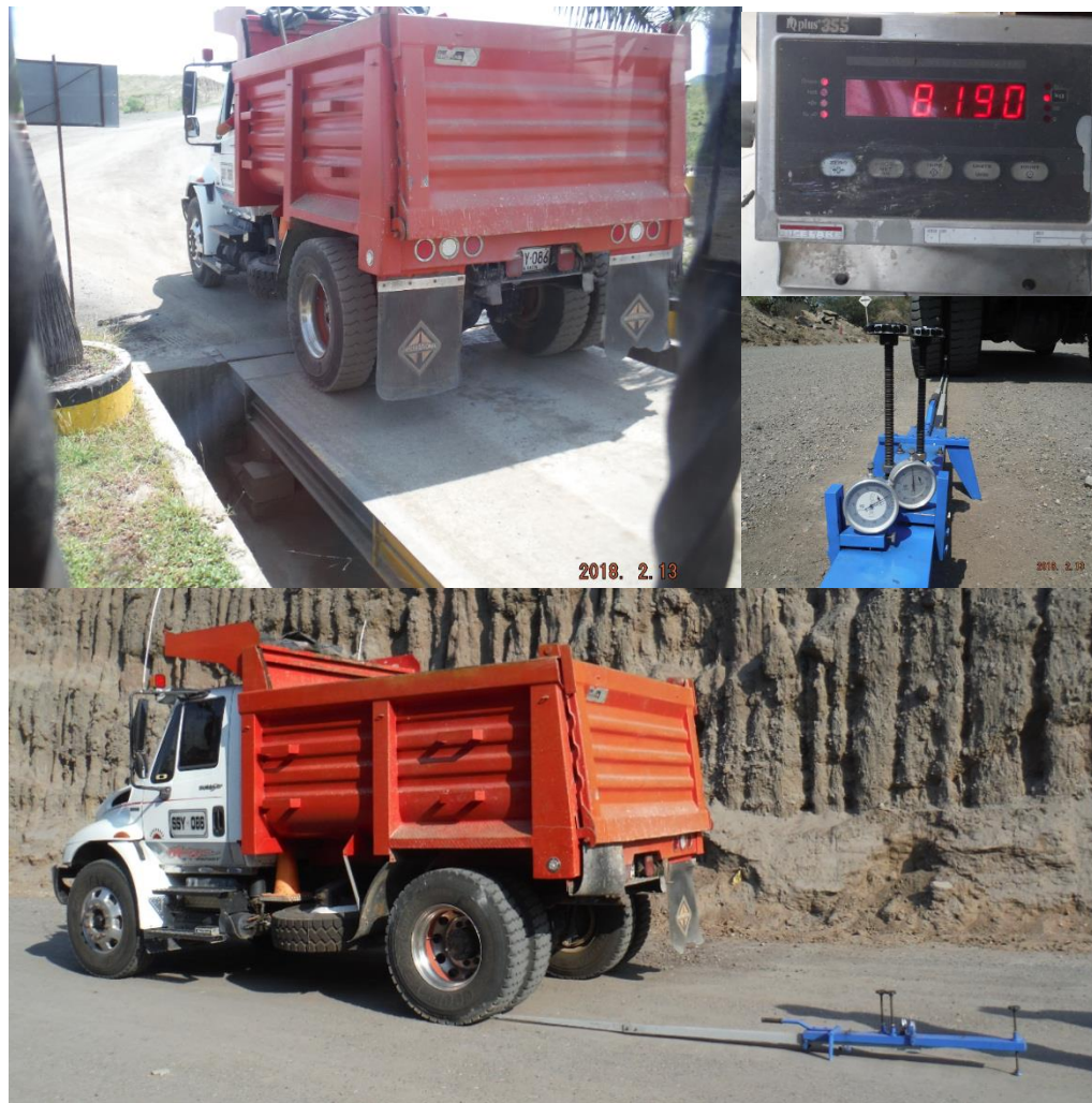
Grafica No 21. Calibración de la carga de la volqueta y ensayo de viga Benkelman
