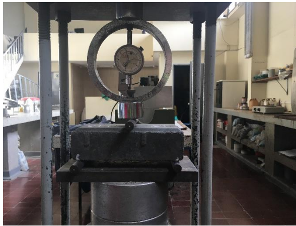
Figura 7.8 Ensayo de resistencia a la flexión de adoquines realizado por el autor en el laboratorio de materiales de la Universidad del Cauca (Fuente propia)
