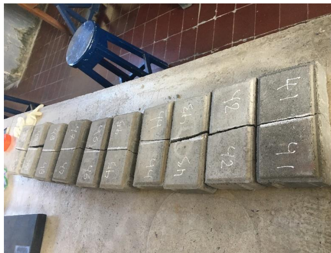
Figura 8.1 Adoquines utilizados en el proyecto después del ensayo de resistencia a la flexotracción. (Fuente propia)
