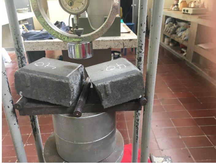
Figura 9.1 Ensayo de resistencia a la flexotracción del proyecto (Fuente propia)
