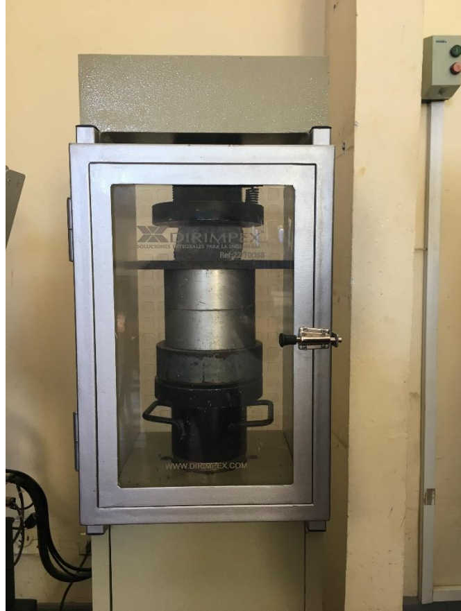
Figura 9.2 Ensayo de resistencia a la compresión del proyecto (Fuente propia)
