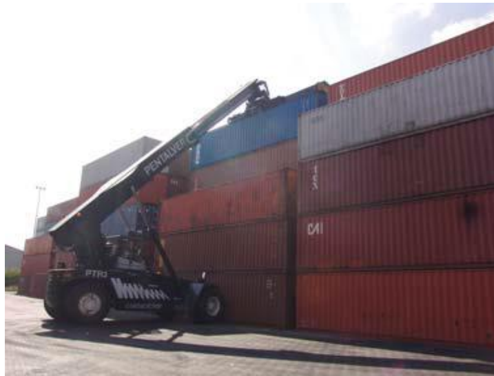
Figura 9.4 Carga de contenedores sobre pavimento articulado. (The precast concrete paving and kerb association, 2007)
