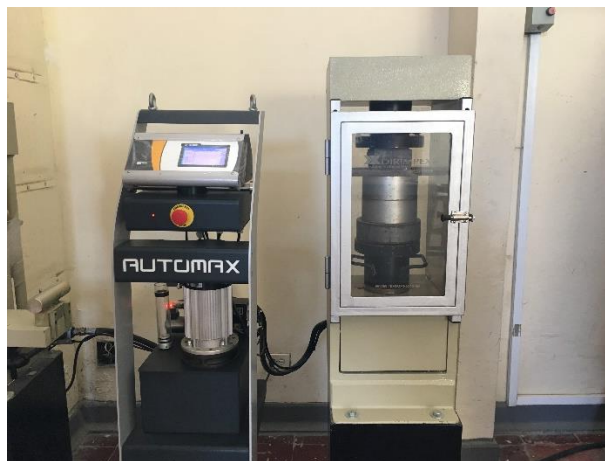
Figura 7.7 Ensayo de resistencia a la compresión de adoquines realizado por el autor en el laboratorio de materiales de la Universidad del Cauca (Fuente propia)
