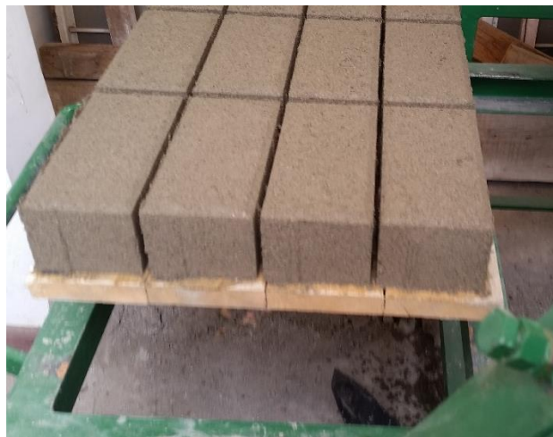
Figura 7.5 Adoquines de concreto producidos por el Autor (Fuente propia)
