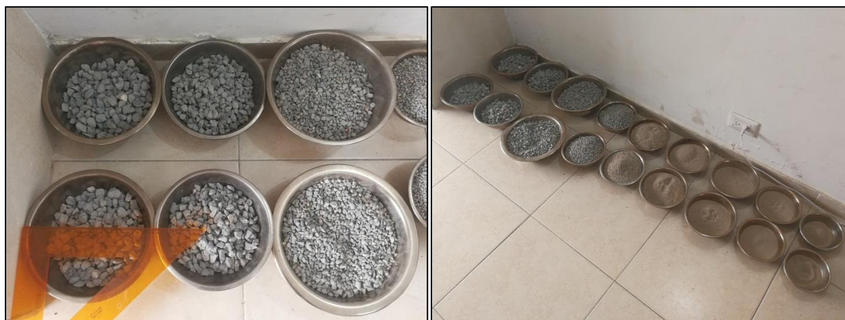
Fotografía 1. Separación de agregados individuales en la serie de mallas
