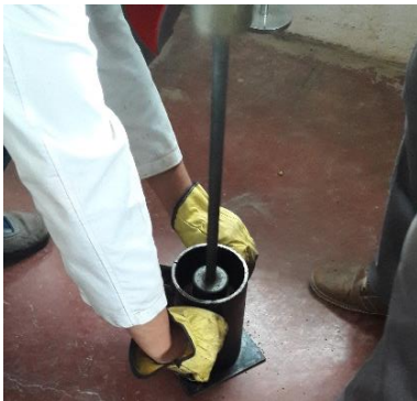
Fotografía 15. Compactación primera capa de especímenes de prueba. Fuente: Esta investigación.
