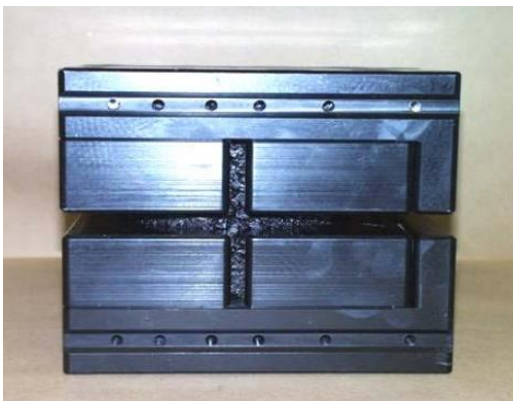
Fotografía 4. Caja de corte con espécimen preparado.
