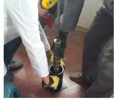
Fotografía 11. Compactación de capa inferior en molde Marshall.
