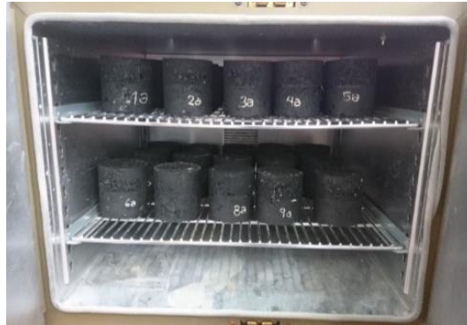
Fotografía 20. Acondicionamiento de especímenes de prueba en cámara termostática. Fuente: Esta investigación.
