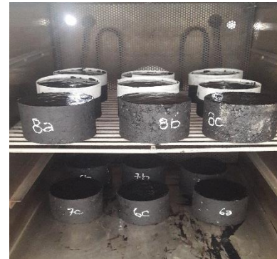
Fotografía 17. Especímenes en cámara termostática. Fuente: Esta investigación.
