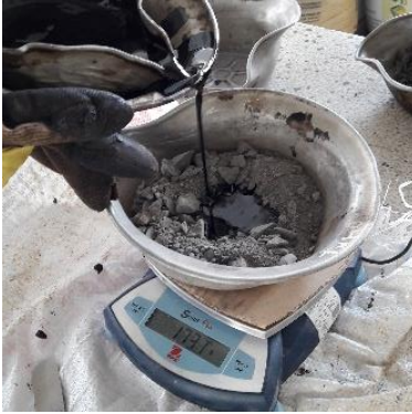
Fotografía 9. Adición de cemento asfáltico.
