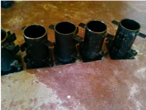
Fotografía 18. Moldes para compactación de segunda capa.
