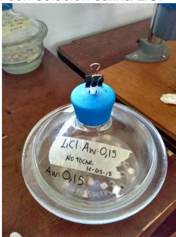
Figura 9. Muestra en desecador con solución salina  $\text{KCl}$
