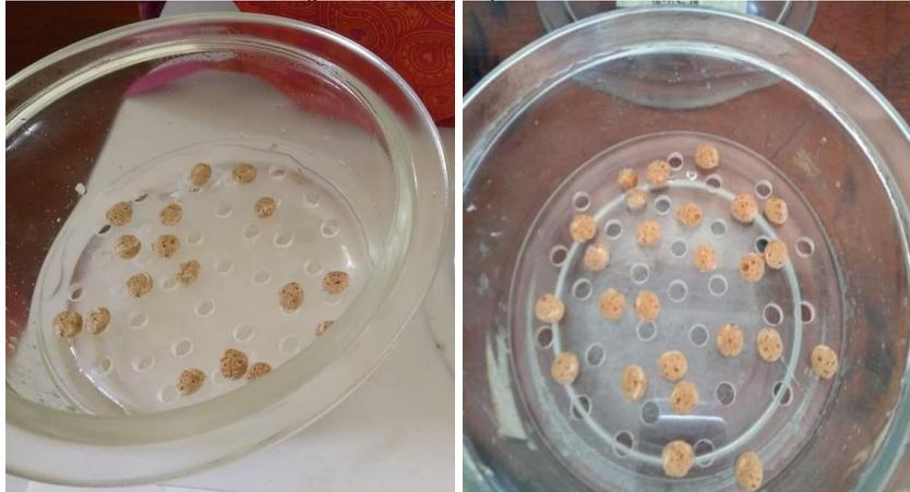
Figura 11. Muestras con crecimiento fúngico extraída de desecador con solución salina KCl ( $A_w:0,85$ )
