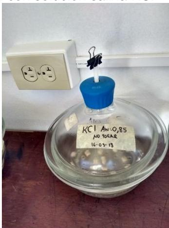
Figura 10. Muestra en desecador (parte interna)
