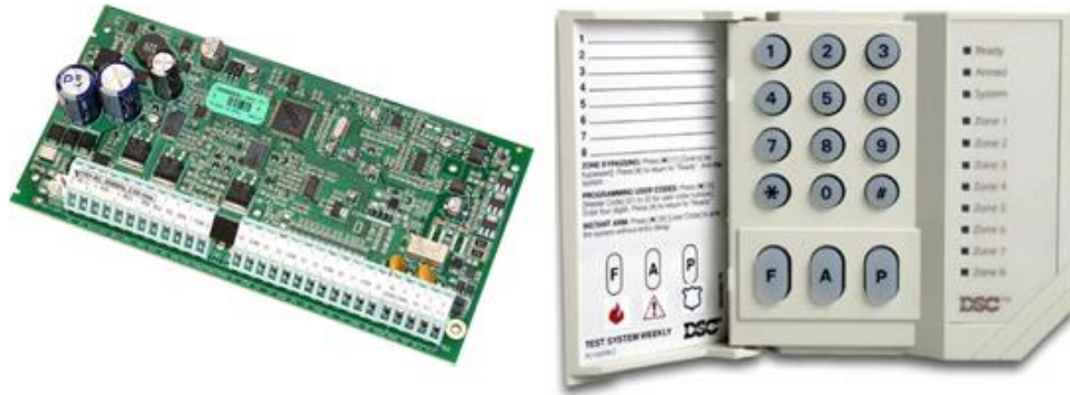
(a) (b) Figura 3.5 (a) Panel de Alarmas DSC 1832 V4.2 y (b) Teclado PC1555.
