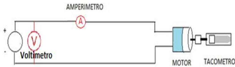
Figura 5. Obtención de parámetros para determinar la constante electromotriz.
