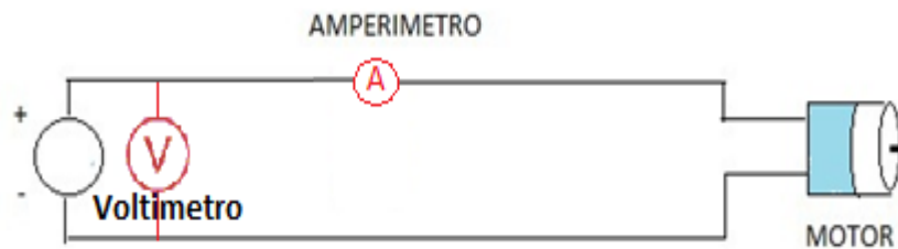
Figura 9. Configuración para la medición de la corriente de arranque.
