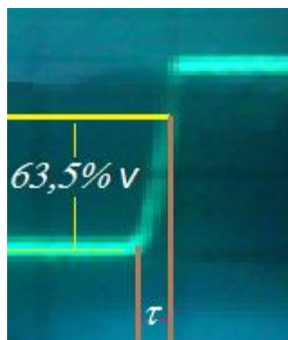
Figura 8. Medida de la constante de tiempo mecánica.
