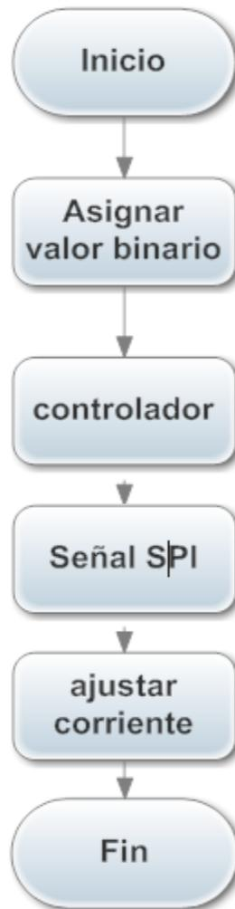
*Figura 22. Diagrama de Flujo Control de Par.*
