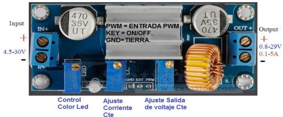
Figura 4. Esquema Físico del Módulo ICESA001A.
