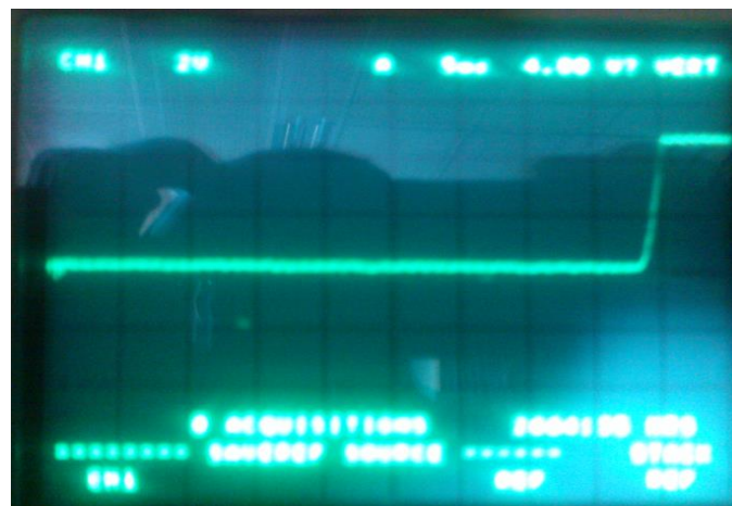
Figura 12. Respuesta del motor ante una excitación de voltaje con onda cuadrada.
