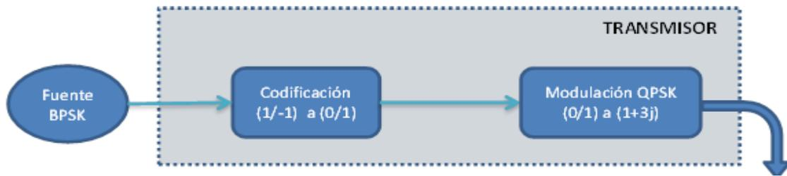
**Figura 3.3. Diagrama de bloques del transmisor**
