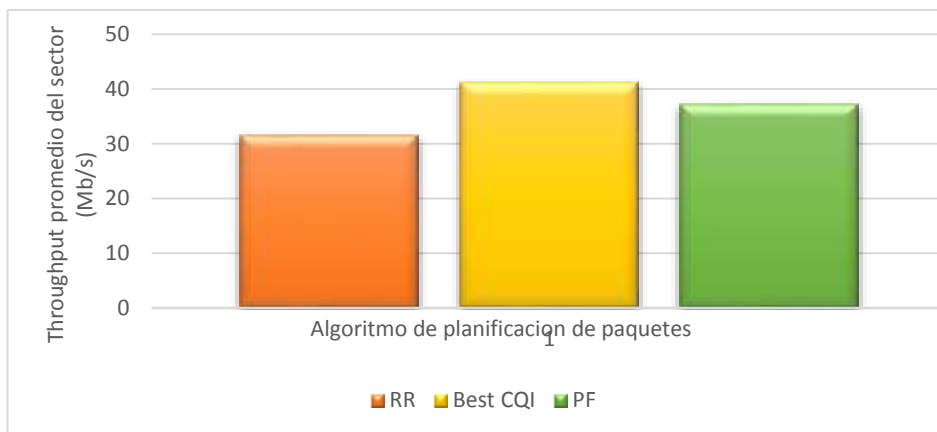
Figura A.2 Throughput del sector para BW de 10 MHz.
