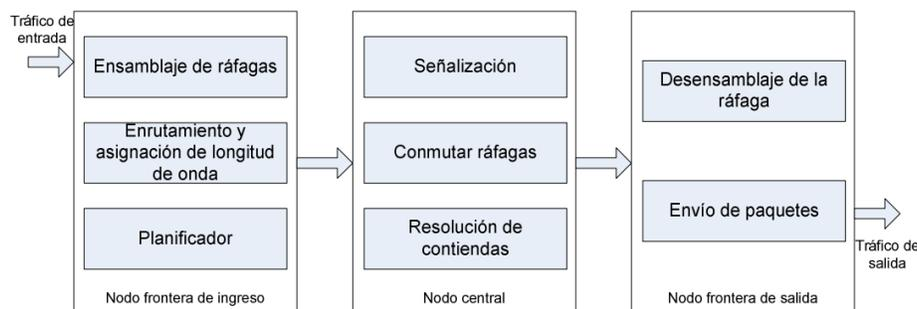
Figura 2.6. Diagrama de funciones en OBS. Adaptada de [43].
