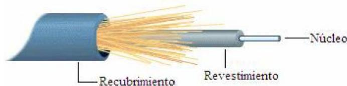
Figura A.1.1. Estructura de la Fibra Óptica. Tomada de [1].
