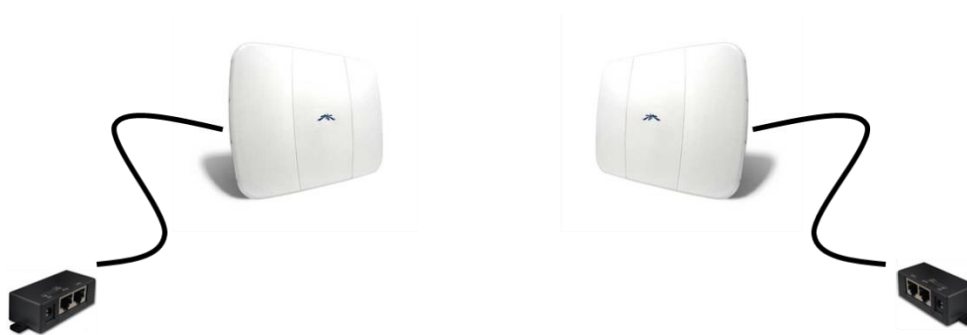
Figura 3.22 Montaje de los PS2 con conectores PoE.
