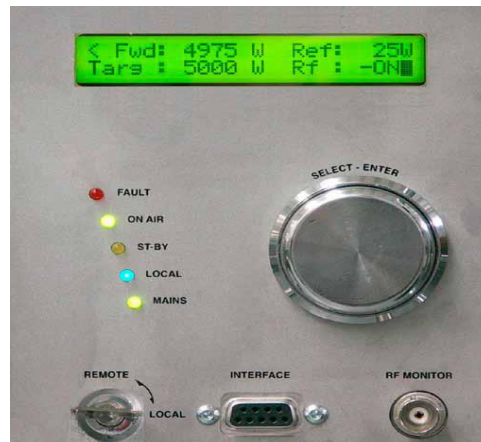
Figura 2.3 Imagen frontal del transmisor con la interfaz de gestión y control.
