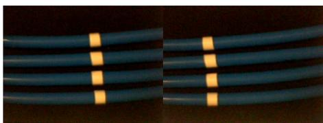
Figura 7: desplazamiento de los tubos neumáticos
