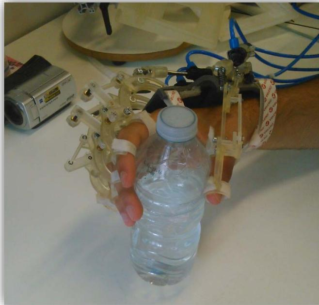
Figura F.4 Mecanismo sujetando botella plástica
