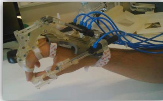
Figura 5.13 Mecanismo exoesqueleto utilizado por un usuario
