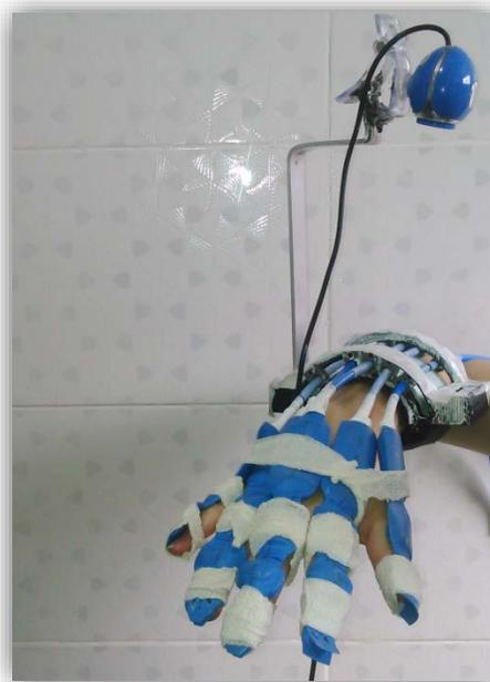
Figura 5.5 Mecanismo termoretráctil vista frontal
