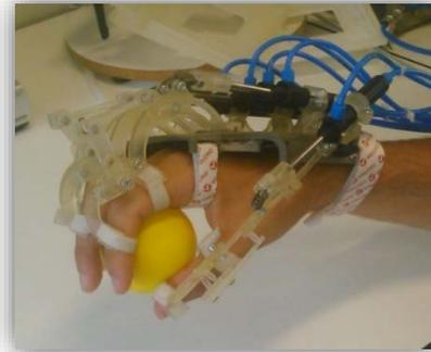
Figura F.1 Mecanismo sujetando bola de 60 mm de diámetro.
