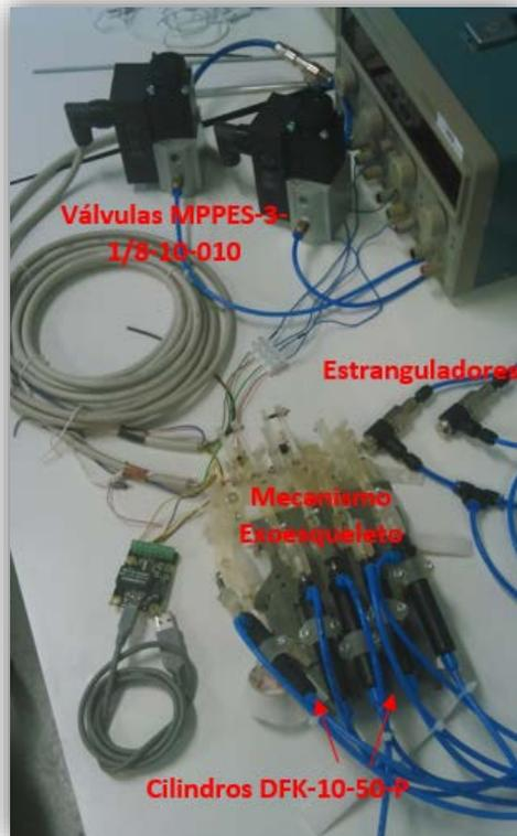
Figura 5.11 Sistema neumático
