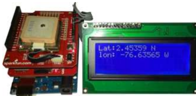
Figura 2.23 Prueba de receptor GPS, memoria microSD, Arduino UNO y LCD I 2 C.
