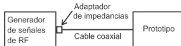
Figura 3.19 Montaje para medir RSSI.
