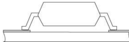
Figura 2.32 Montaje de dispositivo superficial.
