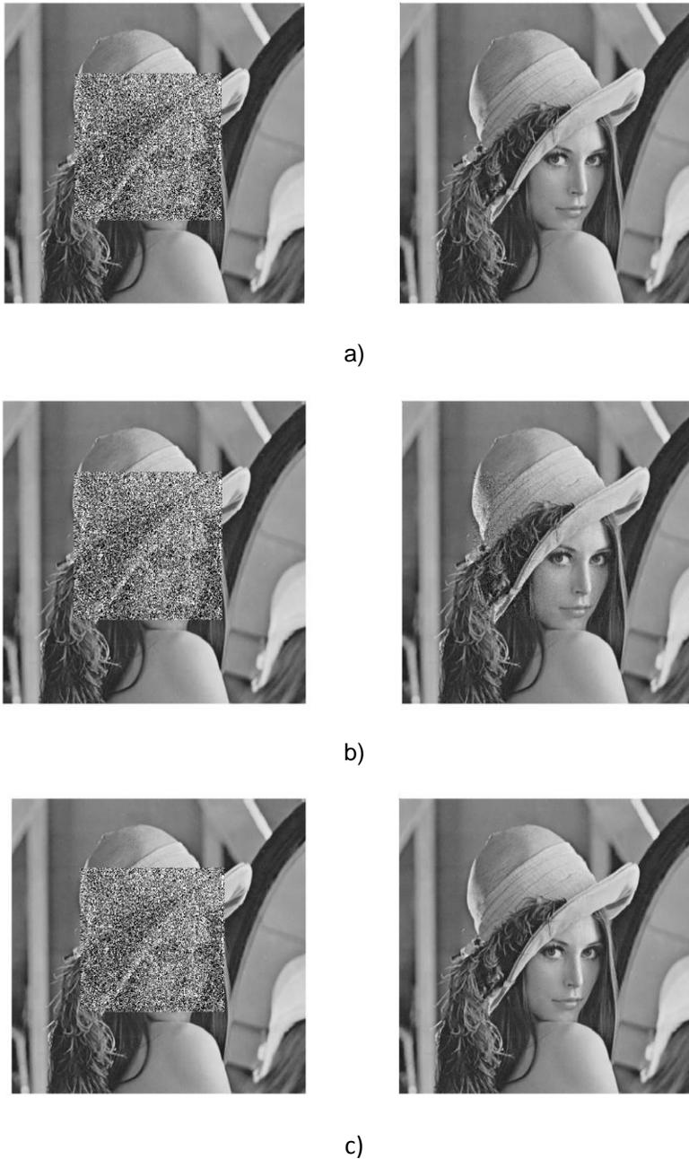
**Figura 4. 11.** Imágenes filtradas para los algoritmos a) LMS, b) NLMS y c) ARy afectada por ruido gaussiano en un sector.
