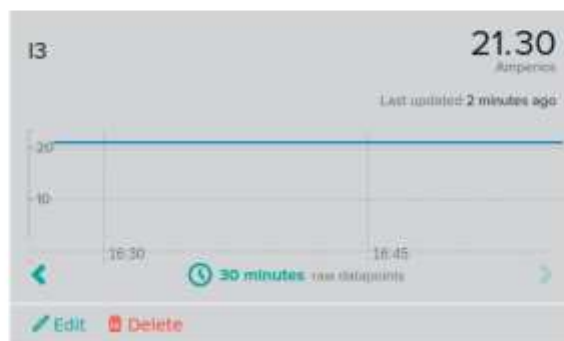
Figura 4.12 Corriente en el transmisor de Unicauca Estéreo
