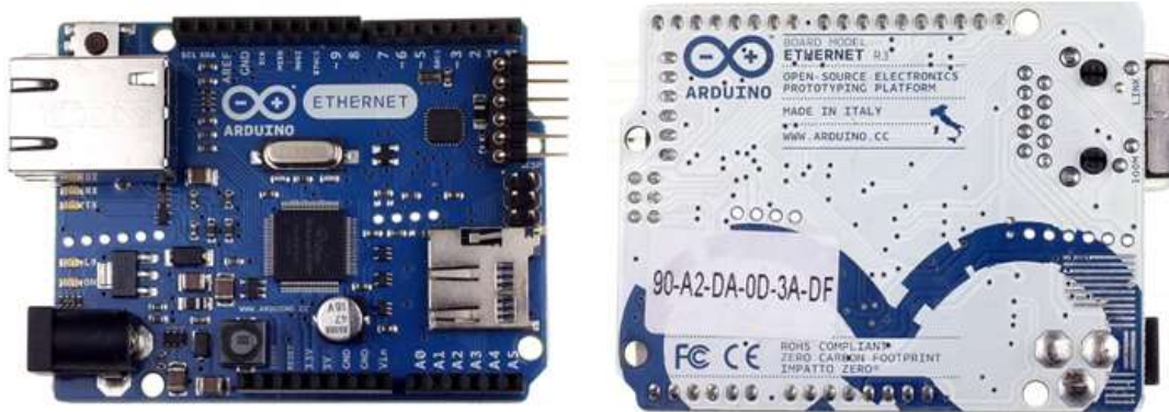
Figura 3.4 Arduino Ethernet del nodo coordinador [19]
