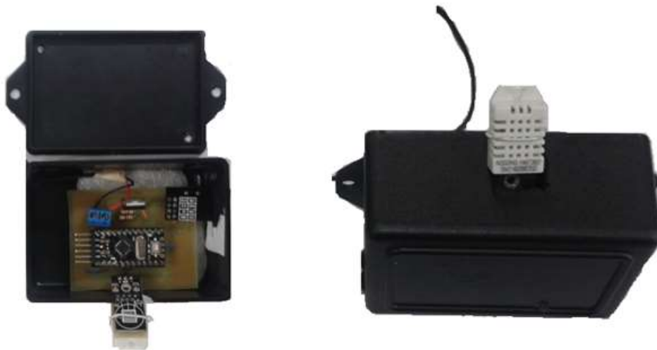
Figura 3.17 Versión final del nodo de temperatura y humedad
