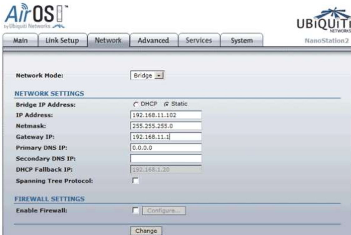
Figura B.4 Cambio de IP del dispositivo NanoStation 2
