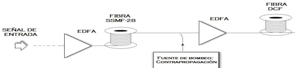
Figura 2.3 Esquema para una configuración de Inyección Raman con amplificación EDFA.
