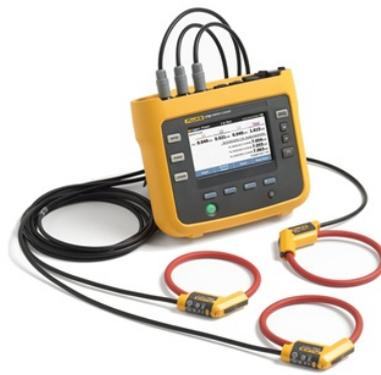
Figura 4.3: Medidor de energía con bobinas Rogowsky.
