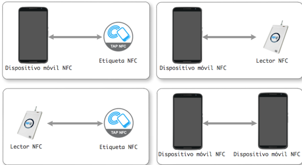
Figura 2.2: Tipos de interacción entre dispositivos NFC. Fuente Adaptado de [6].
