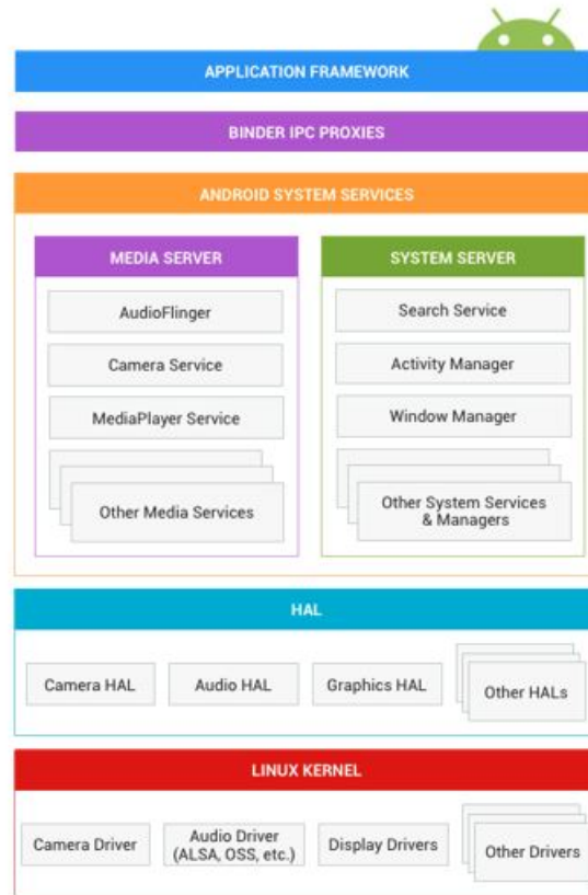
Figura 4.18: Arquitectura del sistema Android. Tomada de [132]
