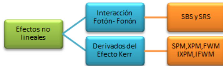
Figura 21. Clasificación de los diferentes efectos no lineales de la fibra óptica.
