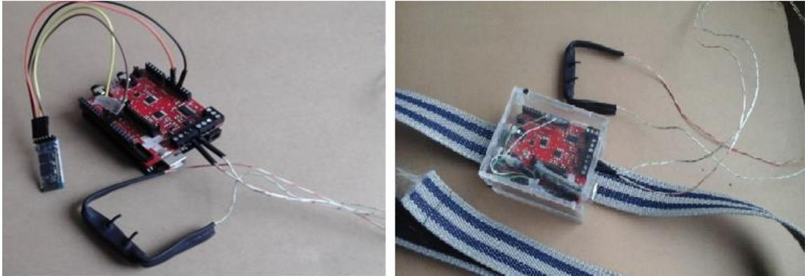
Figura 2.15. Componente para la adquisición y envío de la señal de respiración integrada. Fuente: Propia.
