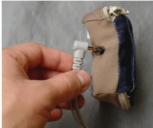
Figura C.9. Conexión del terminal para los electrodos con el componente para ECG. Fuente: Propia.
