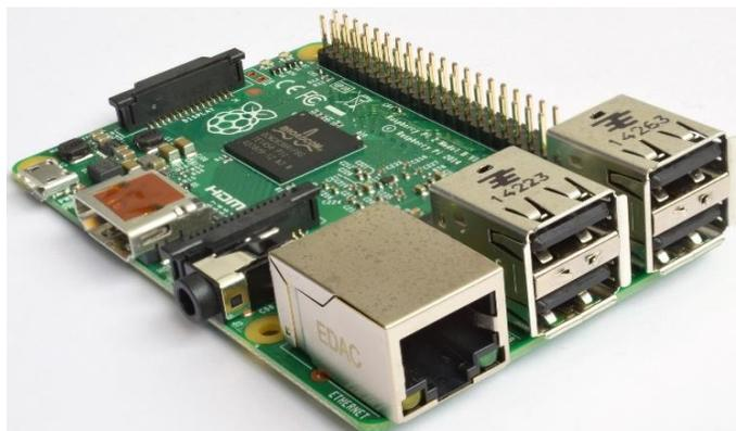
Figura 2.5. Raspberry Pi 2(Modelo B). Fuente: [59].
