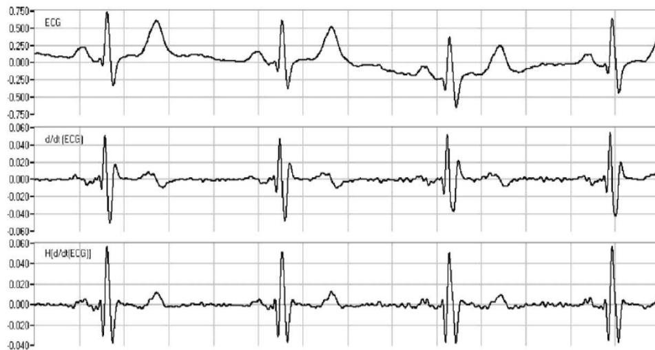
Figura 2.21. Señal de ECG pasada por las etapas de procesamiento, donde ECG es la señal filtrada,  $d/dt(EGC)$  es la derivada de la señal filtrada y  $H(d/dt(EGC))$  es la transformada de Hilbert de la señal derivada. Fuente: [79].
