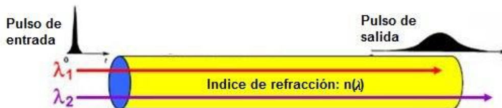
Figura 1.22 Ensanchamiento de un pulso por efecto de la CD [6].
