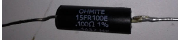
Figura 4.8: Resistencias utilizadas para implementar el banco de cargas. [Fuente: Elaboración Propia]
