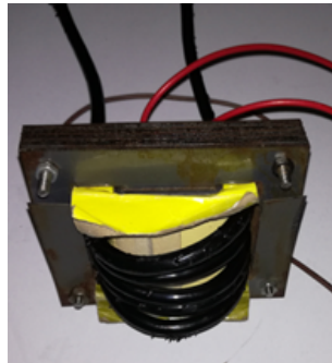
Figura 4.1: Transformador construido previamente al final. [Fuente: [11]]
