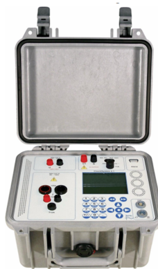
Figura 1.3: Equipo de ensayo con patrón y fuente monofásica clase 0,05 [Tomado de: http://www.mte.ch/home.html ]
